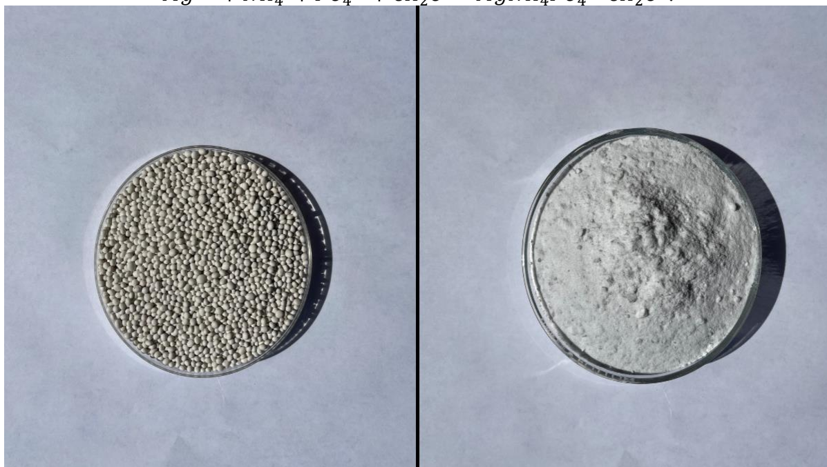
Рисунок 1. Внешний вид минерала струвита в гранулированном виде (слева) и в виде порошка (справа).
