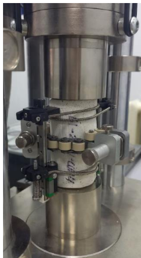
Рисунок 9. Испытание цилиндрического образца твердеющей закладки на испытательном комплексе АСИС.
